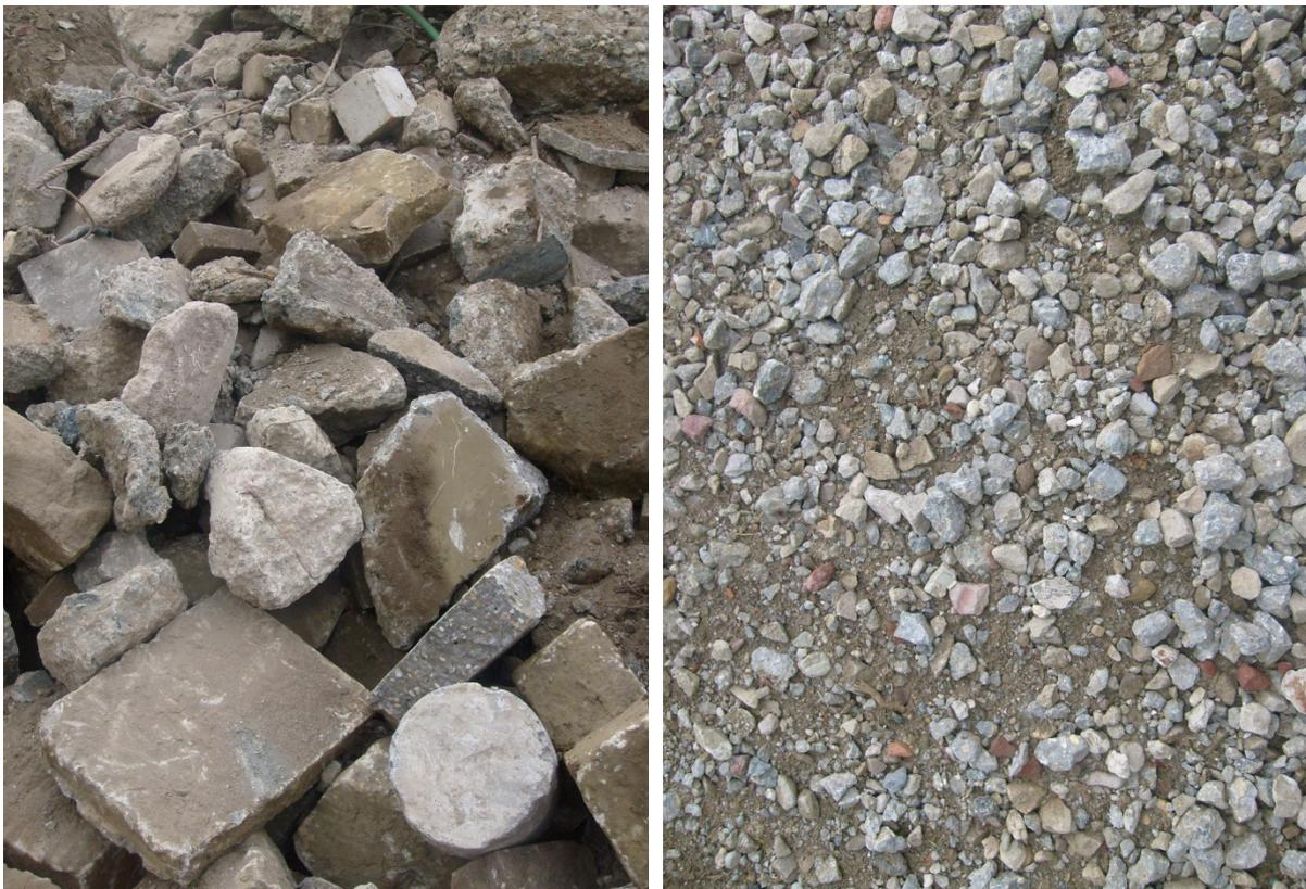
**Bild 6: Fraktion Betonbruch (links) und RC-Frostschutzschicht aufbereitet aus Naturstein/Beton/Ziegel (rechts), Quelle: Harald Kurkowski, Bimolab gGmbH**
